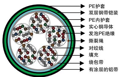
IEC 60708泡皮绝缘，双层钢带铠装&LAP护套填充型电缆
